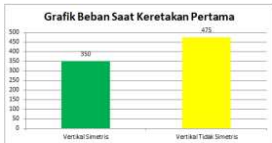
Gambar 14 Beban Saat Keretakan Pertama Pada Kedua Tipe Pembebanan
