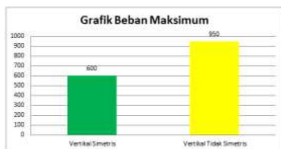
Gambar 15 Beban Maksimum yang Mampu Ditahan Pada Kedua Tipe Pembebanan
