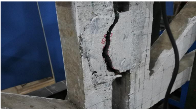
Gambar 12. Pola Retak pada Kuda-Kuda Tipe B Pembebanan Vertikal Tidak Simetris
