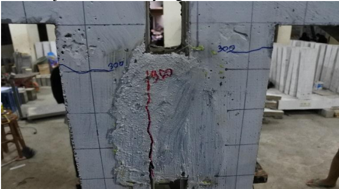
Gambar 12. Pola Retak pada Kuda-Kuda Tipe B Pembebanan Vertikal Tidak Simetris
