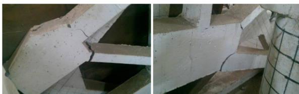
Gambar 2 Pola retak akibat gaya tarik aksial Sumber : Tedy Wonlele; Sri Murni Dewi; Siti Nurlina, 2013 (Jurnal rekayasa sipil/Volume 7-no.1-2013)
