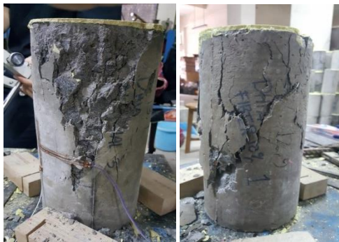
Gambar 4.9 model kehancuran beton normal dan beton dengan fraksi serat 10%
