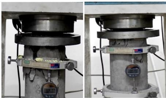
Gambar 9. Model kehancuran kuat tekan beton normal pumice dan beton serat fraksi 20%
