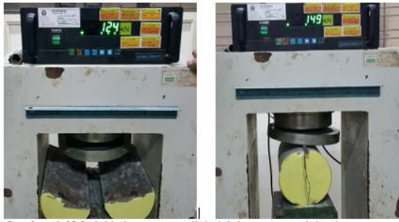
Gambar 6. Model kehancuran tarik belah beton normal dan beton serat fraksi 10%
