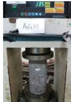
Gambar 4. Pengujian kuat tekan beton porous .
