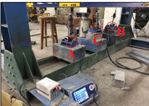
Gambar 3.4 Posisi Perletakan LVDT di Tengah Bentang Model Jembatan Rangka
