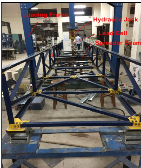
Gambar 3.3 Posisi Pembebanan Beban Uji pada Model Jembatan Rangka Baja
