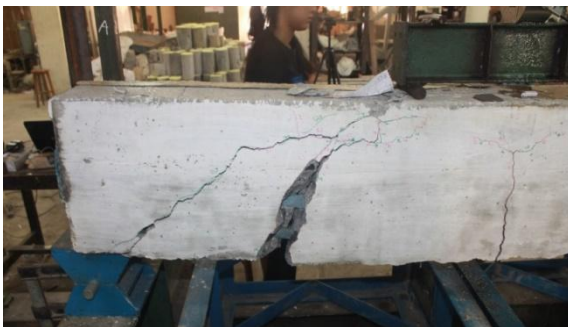
Gambar 17 Lepasnya bagian beton dari balok
