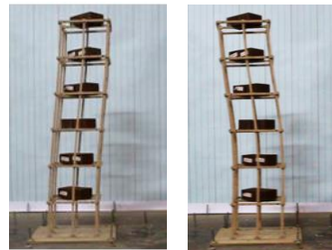
(a) Pengujian simpangan 3 cm
