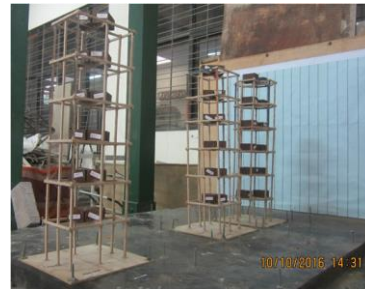
Gambar 6. Model struktur dan mass block yang sudah terpasang
