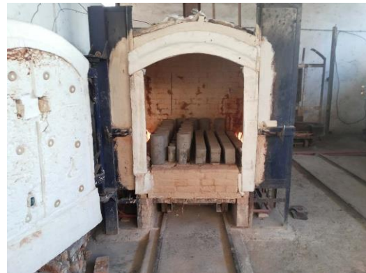
Gambar 3. Proses paparan suhu tinggi balok beton bertulang di dalam tungku pembakaran keramik
