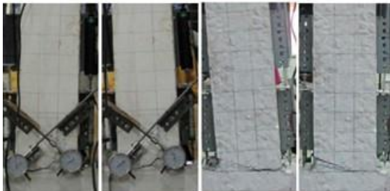
Drift 4% dan -4% sisi depan dan belakang kolom
