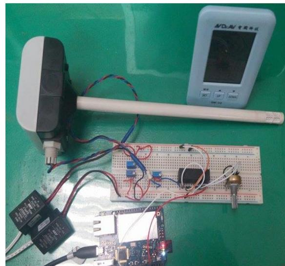
Gambar 4. Modul WiFi dari sensor industri dan higrometer
