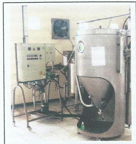
Gambar 2. Alat pengeksrak (ekstraktor) dan *spray drier*
