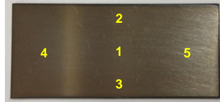
Gambar 3 Posisi untuk pengujian tingkat kekerasan titanium dengan metode microhardness Vickers
