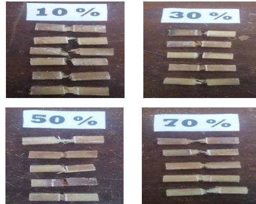
Gambar 13 Hasil patahan spesimen uji impact
