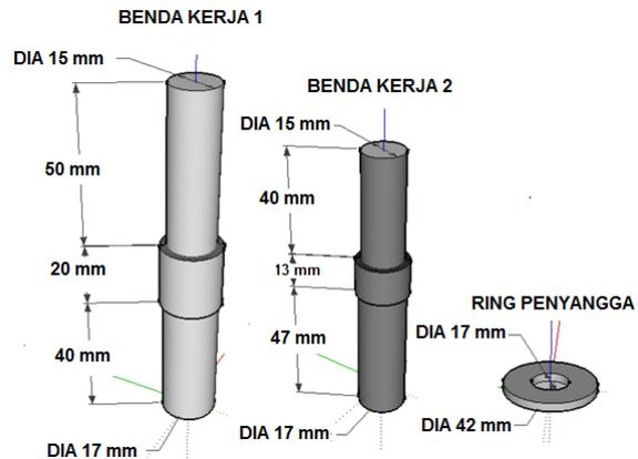
**Gambar 2.** Ukuran Spesimen
