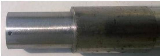
**Gambar 4.** Lubang Tempat Peletakan Termokopel
