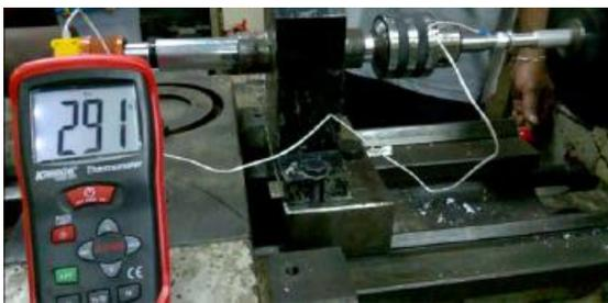
**Gambar 5.** Proses Pengukuran Temperatur pada Saat pengelasan
