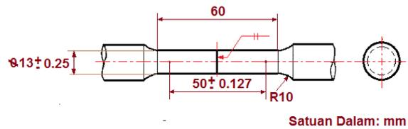
**Gambar 3.** Ukuran Spesimen Uji Tarik
