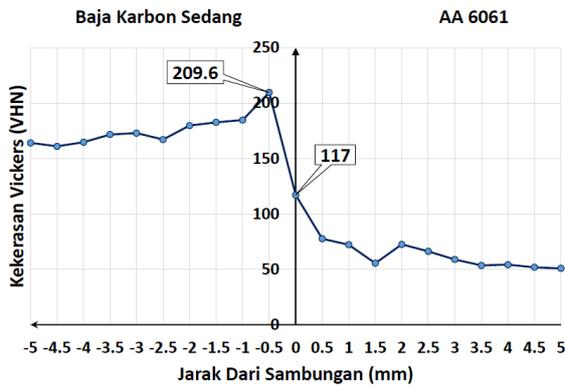
**Gambar 15.** Kekerasan Vickers pada Pengelasan Gesek dengan Kekuatan Tarik Sambungan Terlemah
