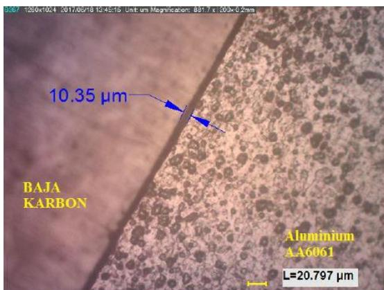
**Gambar 13.** Foto Mikro pada Batas Sambungan dengan Tekanan Gesek 40 MPa, Waktu Gesek 11 Detik,  $\sigma_u = 128,52$  MPa
