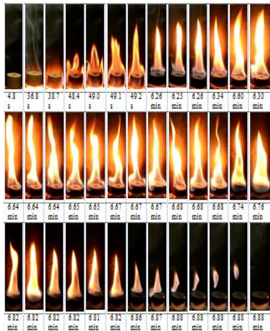
Gambar 13 Proses pembakaran biobriket campuran kulit 64 % dan cangkang karet 27 %
