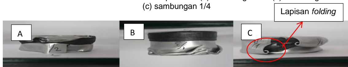
Gambar 7 Pola Deformasi Crash Box Tampak Samping (a) Sambungan 1/2 (b) Sambungan 1/3 (c) sambungan 1/4
