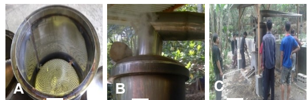
Gambar 2. Profil hasil rancangan alat suling (A. Model cicin berisi air sebagai isolator dan sarangan penahan bahan, B. Model alat destilasi berleher lebar C. Praktek penyulingan minyak serih wangi)
