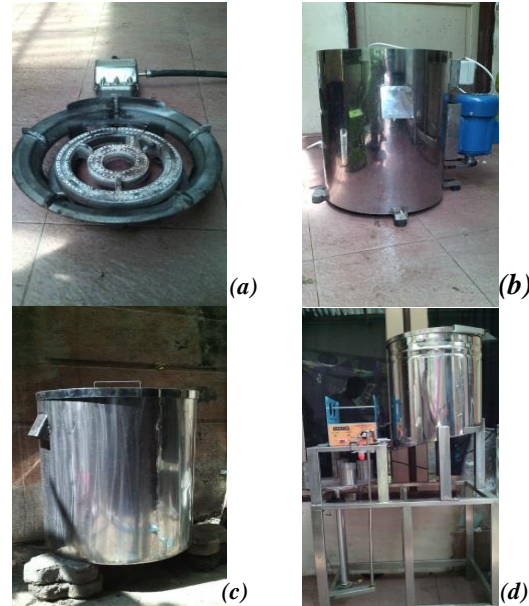
Gambar 2. Kompor industri (a), panci perebus (b), sentrifusa (c), dan pengemas (d)
