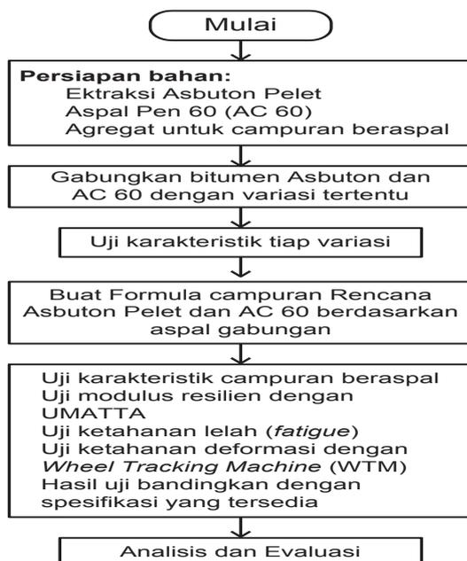
**Gambar 3.** Bagan alir langkah kerja kajian Asbuton bentuk pelet
