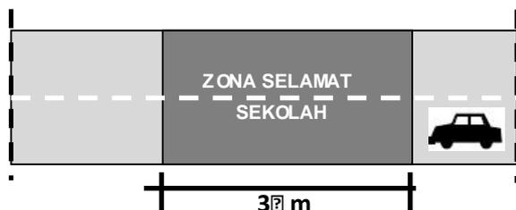
**Gambar 2.** Metode pengukuran kecepatan
