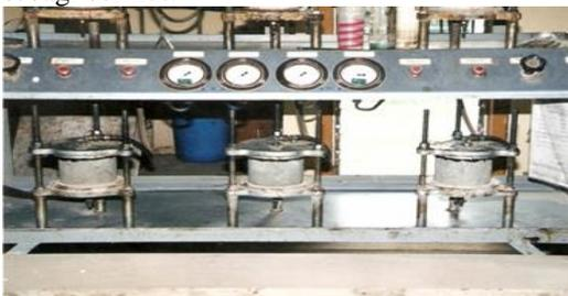
Gambar 4 Pengujian permeabilitas beton
