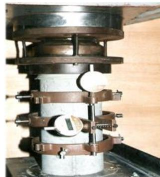
Gambar 3 Pengujian modulus elastisitas.
