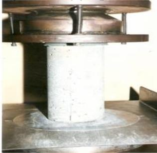
Gambar 1 Pengujian kuat tekan beton
