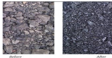
Gambar 1. Recycling aspal sebelum di haluskan dan setelah dihaluskan
