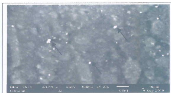
Gambar 13. Struktur morfologi dari Elastomer Termoplastik dengan komposisi 70% karet alam dan 30% monomer, inisiator potasium persulfat 2% dan SDS 1% (kondisi optimum)
