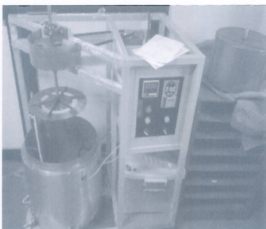
Gambar 2. Rekayasa Alat Immobilisasi Katalis Kapasitas 5 kg
