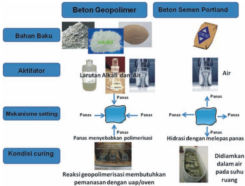
Gambar 3. Perbedaan pembuatan beton geopolimer dan beton semen Portland (Hardjito dkk., 2011)
