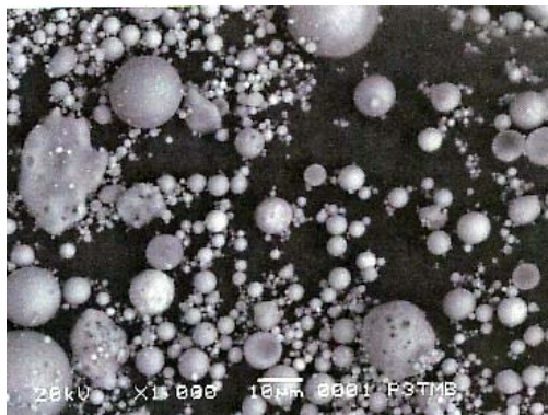
Gambar 3. Data XRD, bentuk partikel dan distribusi ukuran abu terbang Suralaya (Ngurah dan Muchtar 2007)
