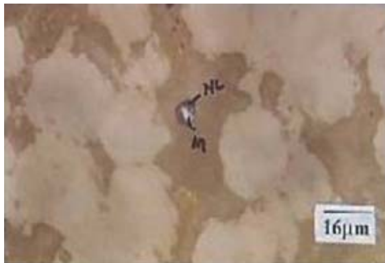
Gambar 9. Fotomikrograf kaolin Nagreg hasil percobaan pemisahan oksida besi, ditemukan magnetit (M) interlock dengan mineral bukan logam (NL)
