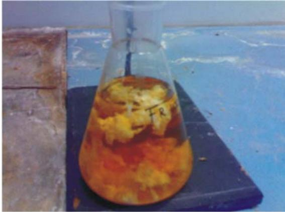
Gambar 5. Presipitat aluminium hidroksida dalam larutan sodium aluminat
