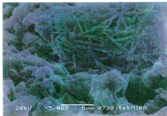
Gambar 5. Tekstur kristal-kristal mulit memanjang menyerupai jarum ( needle-like mullite ) pada komposisi \text{Al}_2\text{O}_3/\text{SiO}_2 = 90 : 10
