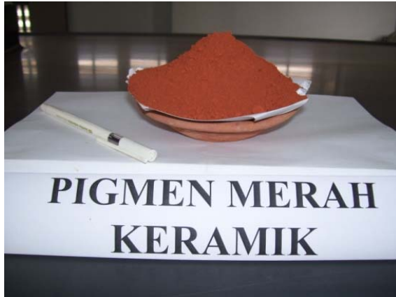
Gambar 9. Residu akhir (non magnetik) berupa pigmen merah (dimanfaatkan untuk keramik)
