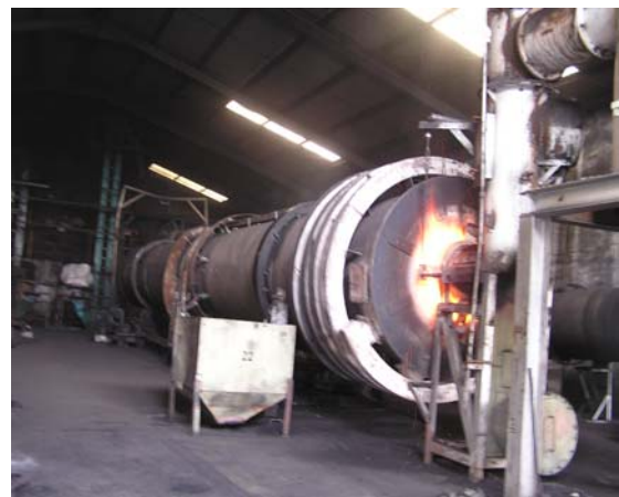
Gambar 1. a. Bagan alir proses pembuatan b. Rotary kiln sistem direct fire karbon aktif dari batubara
