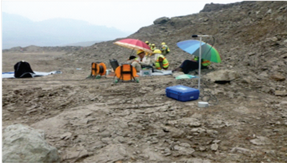
Gambar 4. Aktifitas pengukuran getaran peledakan
