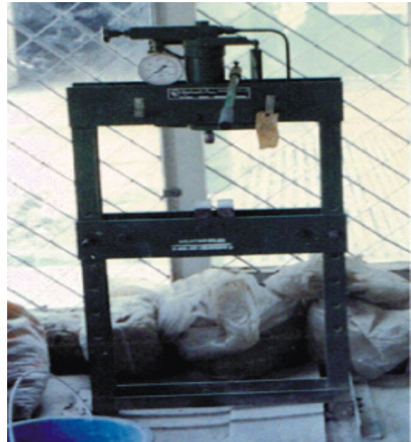
Gambar 3. Alat tekan hidrolik untuk pembentukan benda uji
