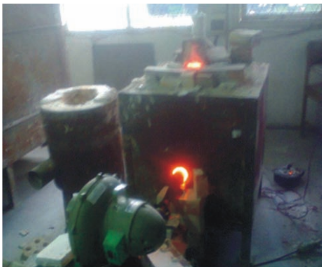
Gambar 4. Tungku gas untuk pembakaran benda uji pada suhu 1100 °C
