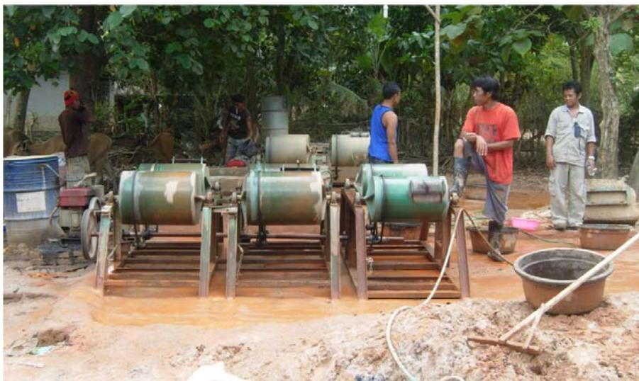
Gambar 2. Pengolahan emas dengan gelundung di tambang rakyat Sekotong
