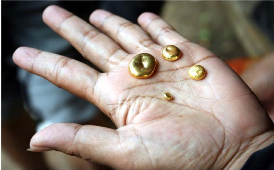
Gambar 3. Hasil gelundung tambang emas rakyat di Sekotong, Lombok Barat
