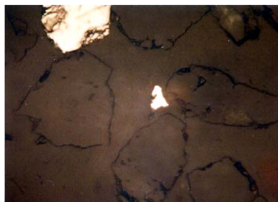
Gambar 2. Partikel emas bebas yang terdapat pada fraksi -200#
