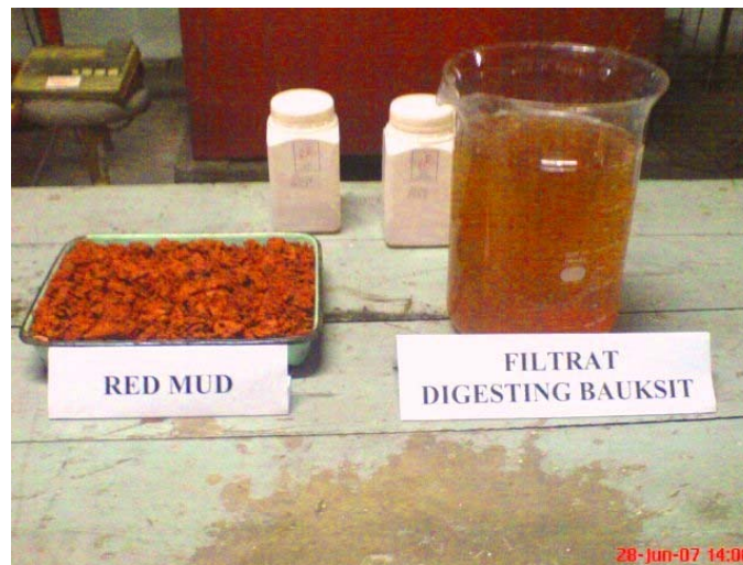
Gambar 2. Red mud dan filtrat sodium aluminat hasil pemrosesan ( digesting ) bauksit dengan bejana tekan
