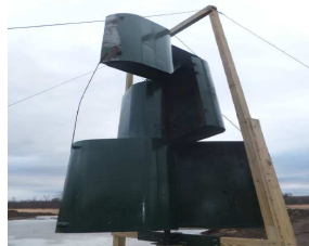
Gambar 2. Prototipe dari Turbin savonius Mark II yang digunakan untuk irigasi (Erik Andrus, 2012)
