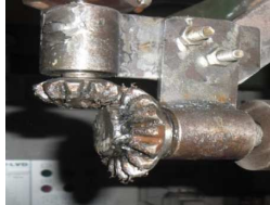
Gambar 6. Sistem transmisi yang digunakan pada pompa air tenaga angin
