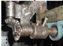
Gambar 7. Mekanisme sambungan poros penggerak yang digunakan.
