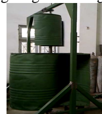
Gambar 5. Rotor Turbin Savonius yang digunakan
