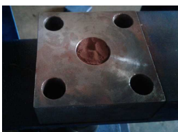
Gambar 5. Pemasukkan serbuk ke dalam dies
