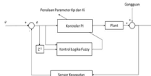
Gambar 19. Diagram blok perancangan kontroler self-tuning parameter PI
