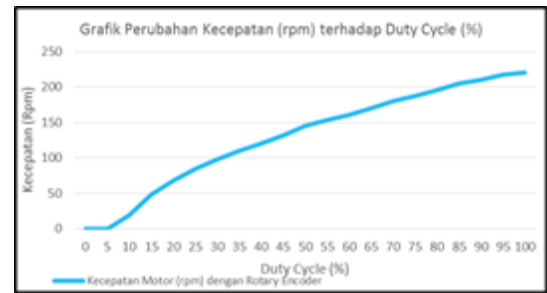
Gambar 4. Perubahan kecepatan motor terhadap duty cycle
