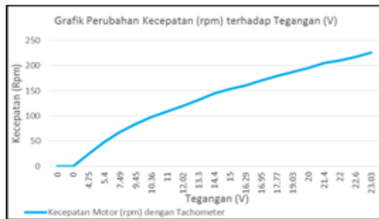
Gambar 2. Perubahan kecepatan motor terhadap input tegangan
