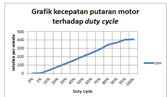
Gambar 3. Grafik Hasil Pengujian Motor DC *Peristaltic Pump* 12V
