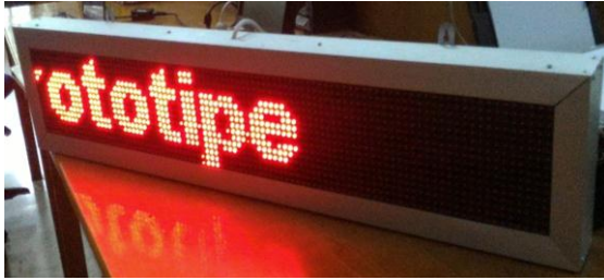
Gambar 10. Running Text Display menampilkan tulisan dari Android
