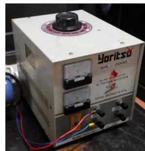
Gbr. 9. Catu daya dengan masukan 220 VAC dan keluaran berupa tegangan mulai dari 0 VDC hingga 2000 VDC.
