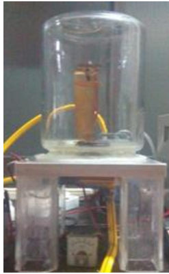
Gbr. 10. Reaktor plasma yang digunakan dalam penelitian.
