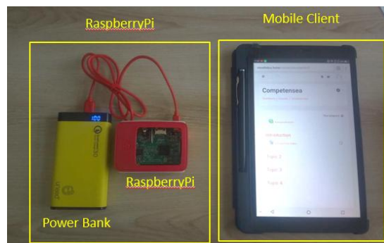
Gambar 4. Raspberry pi sebagai portable server
