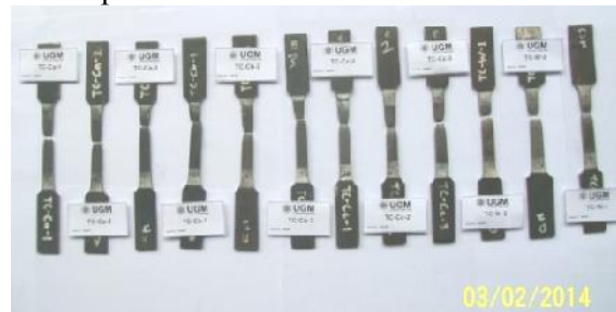
Gambar 8. Benda uji setelah diuji tarik
