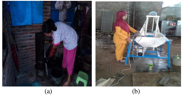
Gambar 13. Perbandingan kondisi Postur Tubuh pada aktivitas pencelupan warna antara (a) sebelum (celup tradisional) dan (b) setelah perancangan mesin pewarna batik (celup mesin)
