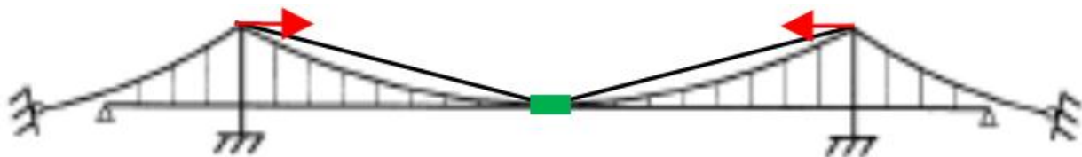
Gambar 3. Sistem klem kabel utama ganda
