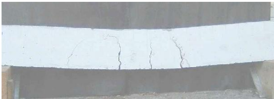
Gambar 9. Keruntuhan lentur balok beton
