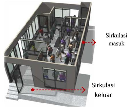
Gambar 27. Perspektif sirkulasi halte dengan tanjakan (*ramp*) berbentuk L (usulan 2)
